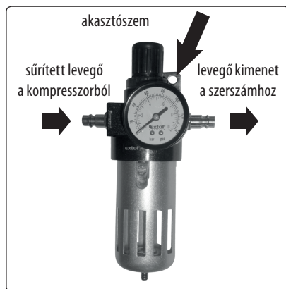
9. ábra. Nyomásszabályozó manométerrel és szűrővel, Extol® 8865104
